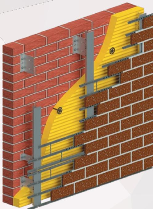
Данная плитка разработана как аналог дорогих клинкеров, изготавливается из Фибробетона, имеет высокие прочностные характеристики, а форма плитки полностью соответствует еврозразмеру 240 x 71 мм, Плитка имеет два паза и вставляется в «Омега» профиль из нержавеющей стали, межшов-
