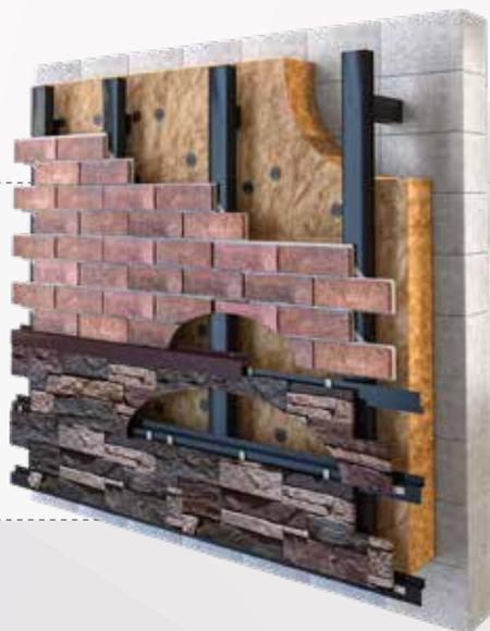
Универсальная схема монтажа сочетает в себе возможность монтажа фасадных панелей любых коллекций. Это достигается путем введения в вертикальную систему локально расположенных горизонтальных z-образных профилей, которые позволяют учесть особенности каждого вида панелей. В данной универсальной схеме, фасадные панели отделяются от цокольной части металлическим отливом.
